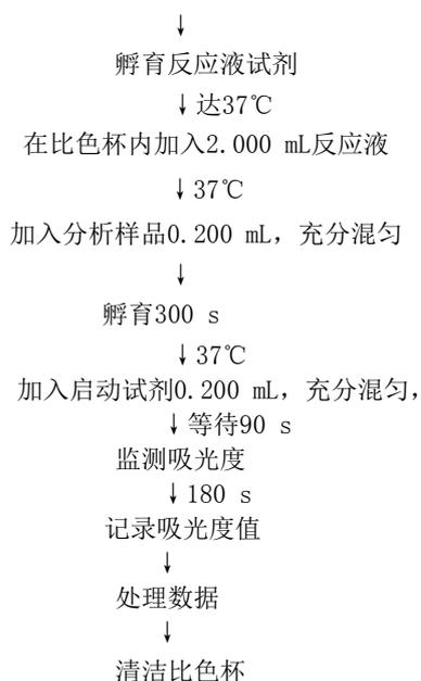
图1 AST参考程序测量流程图
